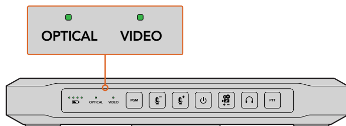
Quando um sinal de vídeo válido for detectado via SDI ou HDMI, você verá o indicador de status "Video" aceso. O indicador "Optical" acenderá quando um sinal SDI válido for detectado via a entrada de fibra óptica.
