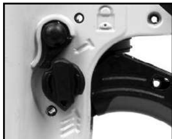
Modo de interruptor de contacto (el interruptor selector del modo de interruptor apunta hacia abajo)
