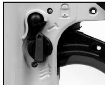
Modo de interruptor en secuencia (el botón selector del modo de interruptor apunta hacia arriba)
