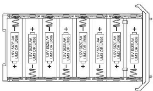
De nouvelles piles, alcalines ou au lithium, de type 'AA' doivent être insérées en respectant l'orientation indiquée sur le compartiment. Comme avec la plupart des appareils électroniques, l'orientation négative (-) des piles devrait être contre les ressorts. Ne pas insérer les piles correctement endommagera l'appareil.
