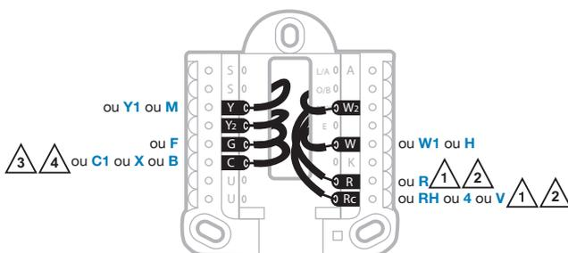
3. Si l'ancien thermostat avait uniquement un fil **C** ou **C1**, connectez-le à la borne **C**. Si l'ancien thermostat avait deux fils **C** ou **C1**, enroulez chaque fil séparément dans du ruban électrique sans les brancher.
