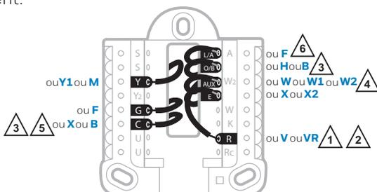
**REMARQUE :** N'utilisez **PAS** la borne **W** si vous avez une thermopompe. Branchez le chauffage auxiliaire à la borne **AUX** ou **E**.
