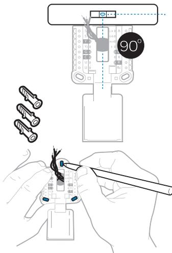
**12 Réglez la position du contacteur R et insérez le ou les fils R.**
