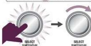
Pour sélectionner l'heure de démarrage automatique, tournez le cadran SELECT vers la gauche ou vers la droite. Pour accélérer ou ralentir le rythme, de réglage tournez le cadran SELECT plus vite ou plus lentement. Lorsque l'heure requise aura été atteinte, pressez le cadran SELECT pour la régler.
