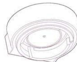
7. Réinsérez, par ordre, la plaque de dispersion, l'écran diffuseur et la vis. Avec vos doigts, tournez la vis en sens horaire sur 2-3 tours, puis serrez-la à l'aide de la clé Allen jusqu'à ce qu'elle soit de niveau avec l'écran diffuseur. Ne pas trop serrer la vis.
