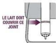
Pour amorcer le moussage, pressez le levier de vapeur et le relâcher. Le moussage s'arrêtera automatiquement lorsque la température du lait sélectionnée sera atteinte. Soulevez la buse vapeur pour retirer le pichet. **Essuyez la buse et l'embout avec un chiffon humide.** Rabaissez complètement la buse vapeur et elle se purgera automatiquement.
