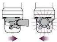
Lorsque la fonction de mouture, dosage et tassage automatiques sera complétée, tournez la poignée du porte-filtre à la position INSERT et abaissez-la pour le retirer.
