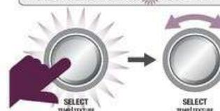
Pressez le cadran SELECT et la durée de polissage en cours clignotera. Tournez le cadran pour sélectionner 2-7 secondes. Pressez le cadran pour régler le temps. La machine bipera une fois pour confirmer les réglages.
