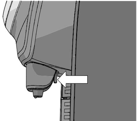
**6** Inserte la boquilla del dispensador en la máquina, prestando atención al clic que indica su correcto funcionamiento.
