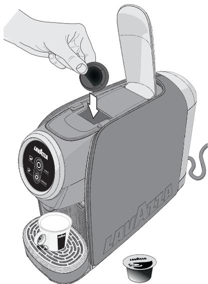
**4** Bajar la palanca de carga de cápsulas para cerrar el compartimiento de introducción de cápsulas.
