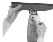
Figure 3 : Assemblage de la buse d'aspiration
