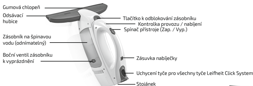
Obrázek 2: Obslužné prvky okenní odsávačky
