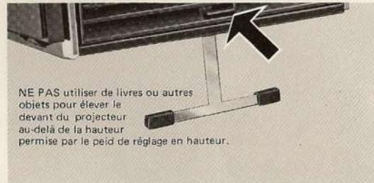
NE PAS utiliser de livres ou autres objets pour éléver le devant du projecteur au-delà de la hauteur permise par le pied de réglage en hauteur.
